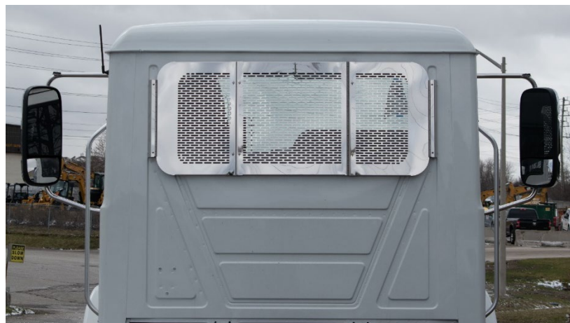
Figura 11: Instalación del Protector de Ventana Trasera terminado
