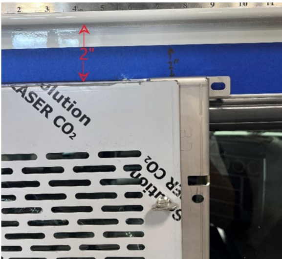
Figura 4: Colocación del OGA en el camión
