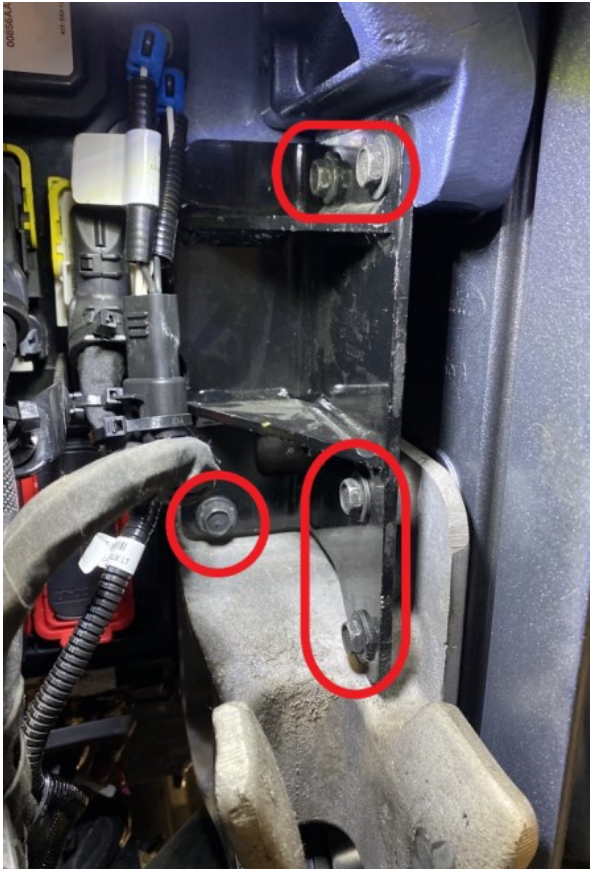
Figure 2 : 5 premiers boulons à retirer (côté conducteur illustré)
