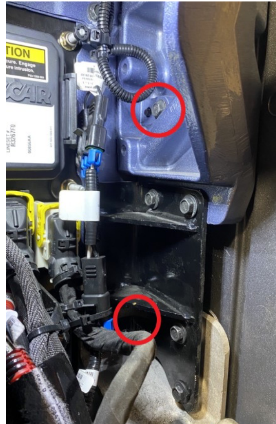
Figure 3 : 2 derniers boulons à retirer (côté conducteur illustré)
