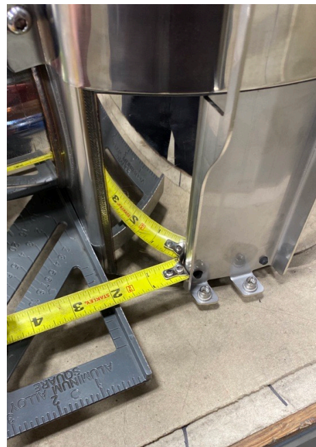
Figure 8 : Mesure de la position du support avant (côté conducteur)
