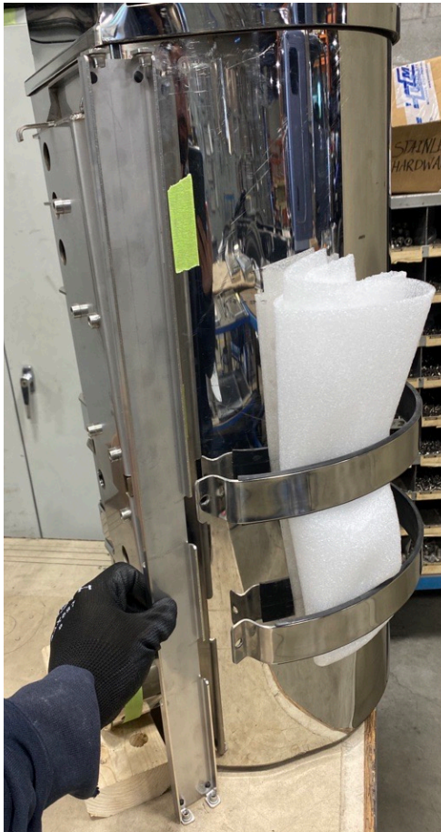
Figure 4 : Orientation du support arrière. (côté conducteur illustré)
