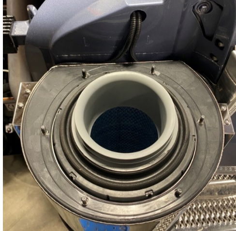
Figure 10 : Faisceau de câblage inséré entre le filtre à air et le panneau en plastique (côté conducteur illustré)
