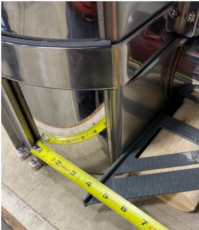
Figura 7: Midiendo la posición del soporte posterior (Lado del piloto)
