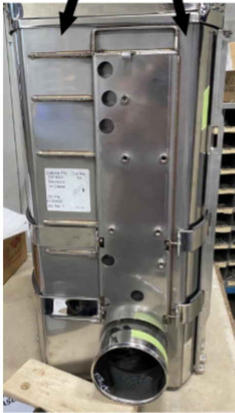
Figura 6: Superficie desde dónde medir al colocar los soportes (Filtro de aire del piloto mostrado)
