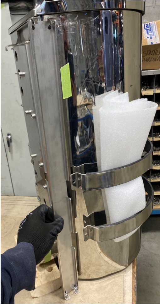
Figura 4: Orientación del soporte posterior (Lado del piloto mostrado)
