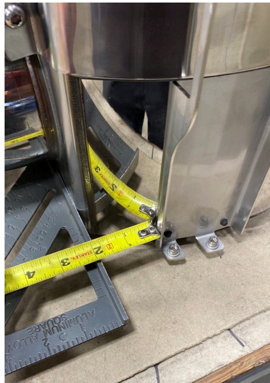
Figura 8: Midiendo posición del soporte frontal (Lado del piloto)
